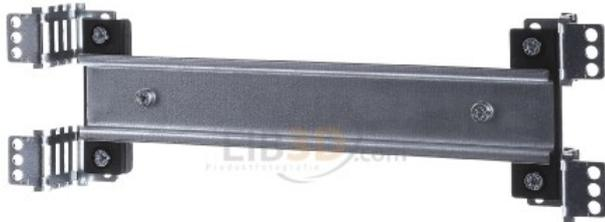
Versión Carril DIN 35/7,5 mm, Material Acero, Protección de la superficie galvanizado en caliente, Forma de agujero Agujero redondo, Distancia entre taladros, central 238 mm, Grosor del material 1 mm, Longitud 7,5 mm, Altura 35 mm
