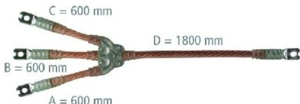
Versión Cable, Número de polos 3, Corriente de cortocircuito máx. 26,5 kA, Sección del cable, lado de fase 95 mm<sup>2</sup>, Sección del cable, lado de tierra 95 mm<sup>2</sup>, Longitud cable de fase a 600 mm, Longitud cable de fase b 600 mm, Longitud cable de fase c 600 mm, Longitud cable de tierra 1800 mm, Elemento de conexión lado de la fase sin, Elemento de conexión lado de la tierra sin, Totalmente aislado no, Material Cobre
