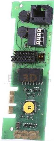
**Módulo de expansión S0/UP0 para COMpact 3000 - S0-Modul para sistema telefonico 90581**
