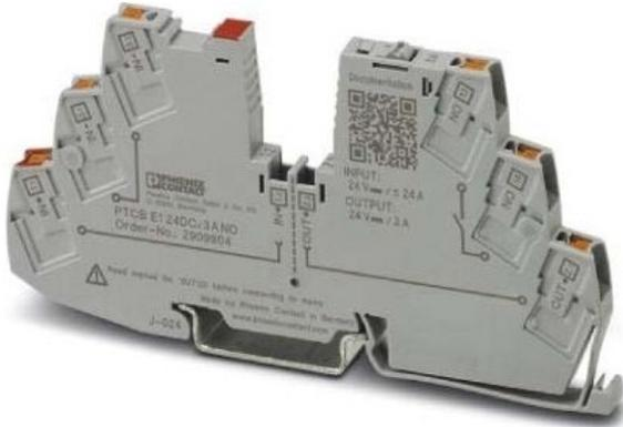
Número de polos 1, Anchura 6,2 mm, Altura 105,8 mm, Profundidad 55,6 mm, Tipo de montaje otros, Tensión de servicio 27,5 V, Intensidad nominal 24 A, tipo de fusible electrónico, Elemento a prueba de fallos 4 A, hora de apagado 0,01 ms, Carga capacitiva máxima 0,02 µF, Con contacto de telecomunicación sí
