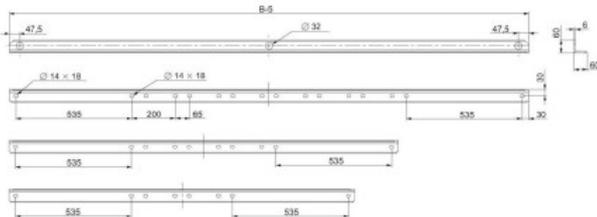
Versión Ángulo de transporte, Anchura 2400 mm, Altura 60 mm, Profundidad 60 mm, Capacidad de carga 3000 kg, Material Metal, Color otros
