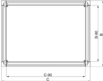
Anchura 400 mm, Altura 300 mm, Profundidad 800 mm, Apto para anchura constructiva de carcasa 400 mm, Apto para profundidad constructiva de carcasa 800 mm, Material Acero, Diseño de la superficie con recubrimiento en polvo, Color gris, Número RAL 7035, Con entrada de cables no
