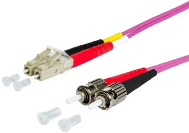
Tipo de fibra Multimodo 50/125, Categoría OM4, Cantidad de fibras 2, Diámetro exterior de la funda de la fibra simple 2 mm, Tipo de cable Dúplex, Longitud 5 m, Tipo de conectores conexión 1 LC dúplex, Tipo de conectores conexión 2 ST, Versión APC conexión 1 no, Versión APC conexión 2 no, Color de la envoltura violeta, Manguito de protección contra dobladuras enchufado, Resistente al fuego según IEC / EN 60332-3-24, Sin halógenos según EN 60754-1/2 sí
