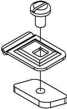
**Titular del divisor - Abrazadera para soporte de cable placa de separación KLWC 16**
