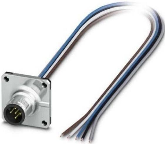
Número de contactos de control 5, Intensidad nominal In 4 A, Temperatura ambiente 85 °C, Tensión nominal 60 V, Categoría de sobretensión II, Grado de ensuciamiento 3, Material del recubrimiento de contacto Níquel, Material de la carcasa Cinc, Recubrimiento carcasa otros, Material del anillo roscado otros, Tipo de bloqueo otros, Con conductor de puesta a tierra no, Grado de protección (IP), montado IP67, Número mínimo de ciclos de acoplamiento 100, Apantallado no, Con indicador de estado no
