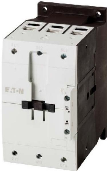
**Contactador de potencia 55kW, 400V AC - Contactor magnético 115A 190 ... 240VAC 0VDC DILMC115(RAC240)**
