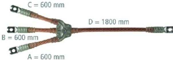
Versión Cable, Número de polos 3, Corriente de cortocircuito máx. 4,5 kA, Sección del cable, lado de fase 16 mm<sup>2</sup>, Sección del cable, lado de tierra 16 mm<sup>2</sup>, Longitud cable de fase a 600 mm, Longitud cable de fase b 600 mm, Longitud cable de fase c 600 mm, Longitud cable de tierra 1800 mm, Elemento de conexión lado de la fase sin, Elemento de conexión lado de la tierra sin, Totalmente aislado no, Material Cobre
