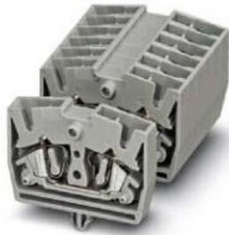
Intensidad nominal In 24 A, Tensión nominal 800 V, Cantidad de pisos 1, Cantidad de puntos de embornado por piso 2, Tipo de montaje otros, Material del aislador otros, Temperatura de servicio -60..105 °C, Anchura 5,15 mm, Altura 32 mm, Profundidad 22 mm, Ejecución con ensayo de explosión "Ex e sí, Placa terminal necesaria sí, Color otros, Niveles puenteados internamente no
