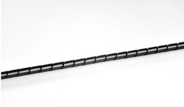
Versión Manguera en espiral, Diámetro nominal 16 mm, Material Plástico, Calidad del material Polietileno (PE), Color negro, Transparente no, Temperatura de servicio -60..80 °C, Temperatura de servicio de corta duración 120 °C, Propiedades de protección contra incendios corresponde a UL94 HB, Sin halógenos sí, Resistente a la radiación UV no, Grosor de pared 1,6 mm, Ancho de la espiral 16 mm, Diámetro del haz 20..150 mm
