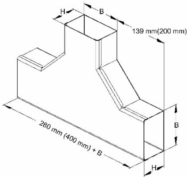
**T, 90 grados - T para canal de cables 60x100mm LUTC 60.100**
