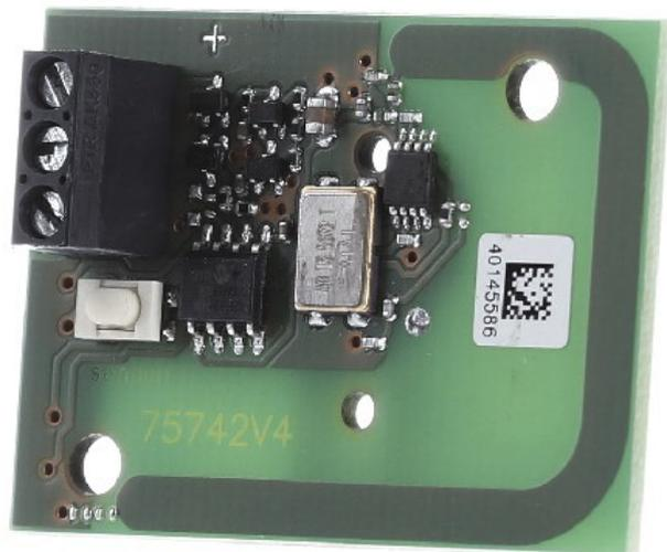
**Placa transmisora de radio - Módulo de expansión para sistema de intercomunicación 1765600**
