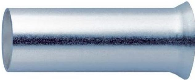
Forma constructiva Estándar, Sección nominal 0,5 mm<sup>2</sup>, Longitud casquillo 8 mm, Aislado no, Material del aislamiento Polipropileno (PP), Sin halógenos no, Color Plata, Material Cobre, Protección de la superficie plateado, Para cables resistentes a cortocircuitos no, Con marcador de identificación no, Género en banda no
