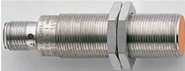
Anchura del sensor 24 mm, Altura del sensor 70 mm, Distancia de conmutación 5 mm, Diseño de la salida de conmutación PNP/NPN, Forma constructiva de la carcasa Cilindro, rosca, Intensidad de salida máx. en la salida segura 400 mA, Tensión de alimentación 10..55 V, Tensión de alimentación de mando nominal Us con CC 10..55 V, Tipo de tensión CC, Material de la carcasa Metal
