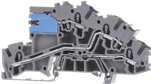
Intensidad nominal In 32 A, Tensión nominal 250 V, Cantidad de potenciales 3, Tipo de montaje Carril DIN TH35, Material del aislador Termoplástico, Temperatura de servicio 105 °C, Anchura 5,2 mm, Altura 96 mm, Profundidad 42,3 mm, Placa terminal necesaria sí, Color base gris, Con función PE sí, Con dispositivo de separación N sí, Posibilidad de función N sí
