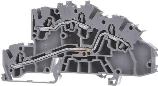
Intensidad nominal In 32 A, Tensión nominal 400 V, Cantidad de potenciales 2, Tipo de montaje Carril DIN TH35, Material del aislador Termoplástico, Temperatura de servicio 105 °C, Anchura 5,2 mm, Altura 96 mm, Profundidad 42,3 mm, Placa terminal necesaria sí, Color base gris, Con función PE no, Con dispositivo de separación N no, Posibilidad de función N no
